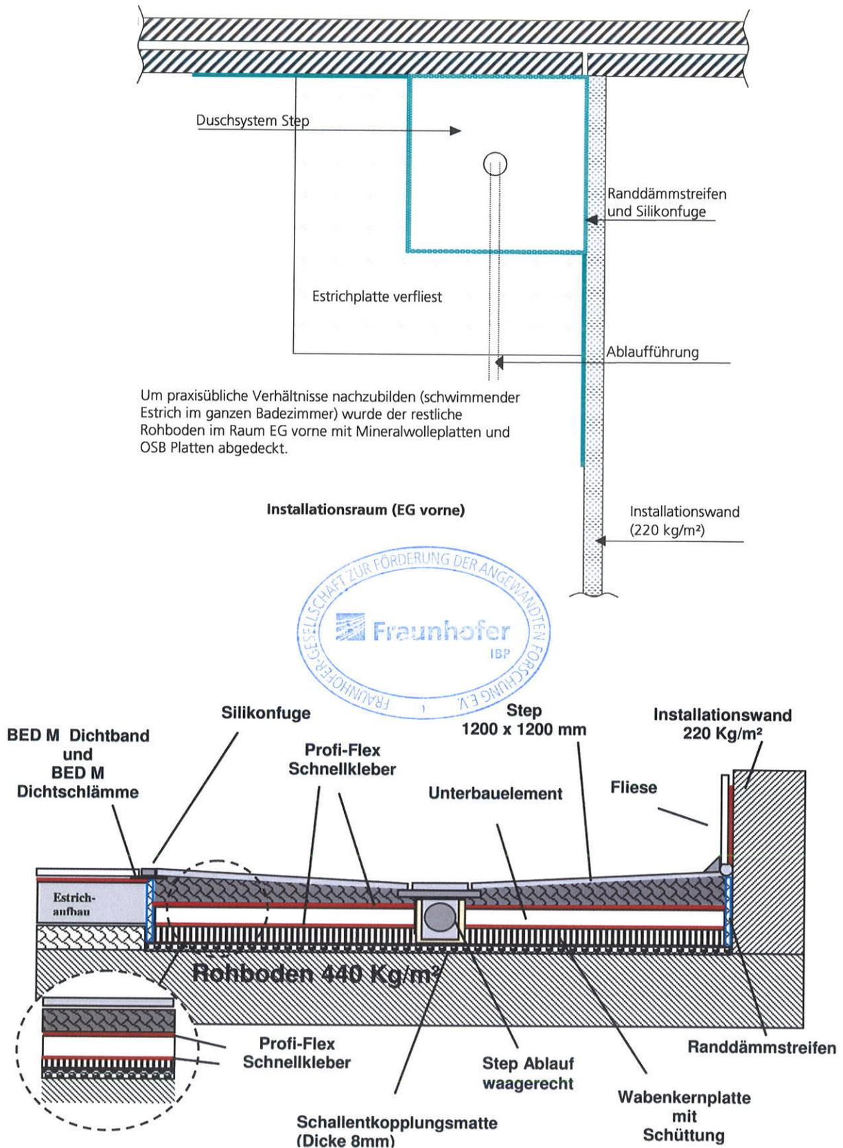
**Bild 3** Lage des Duschsystems im Installationsraum EG vorne (oben) und Schnittzeichnung des Versuchsaufbaus mit Estrichanschluss (unten, Zeichnung des Auftraggebers).
