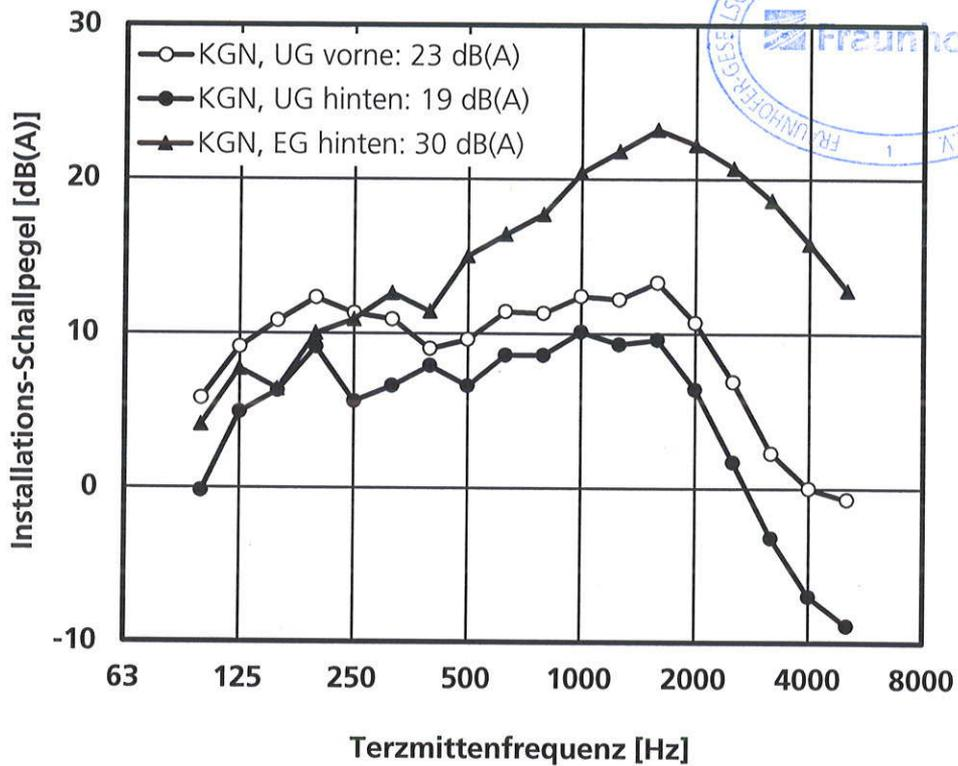
**Bild 1** Frequenzverlauf des Schalldruckpegels bei Geräuschanregung des Duschsystems mit dem Körperschall-Geräuschnormal (KGN; Betriebsdruck: 3 bar, Durchflussrate: 0,25 l/s), gemessen in den Räumen UG vorne, UG hinten und EG hinten. In der Legende sind die Installations-Schallpegel  $L_{AFeq,n}$  ( $L_{in}$ ) in dB(A) nach DIN 4109 für den abgebildeten Frequenzbereich von 100 bis 5000 Hz angegeben.
